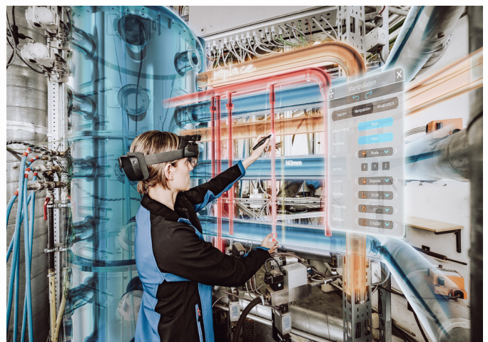
Abbildung 27: AR-Brille unterstützt bei Wartungsarbeiten
