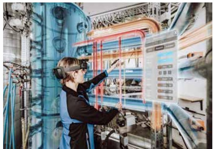
Abbildung 27: AR-Brille unterstützt bei Wartungsarbeiten
